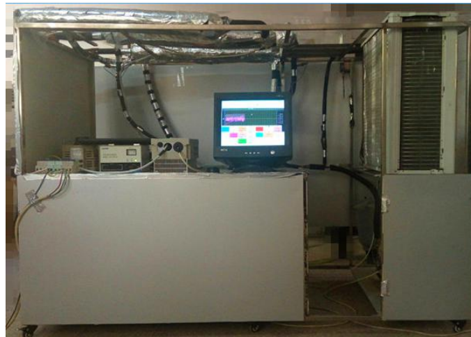
动力型热管内工质流动凝结特性实验台实物图
